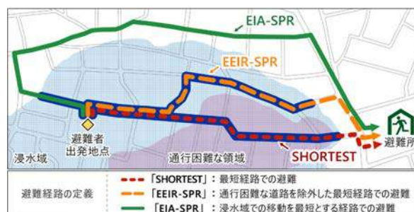
図1 シミュレーションで想定した避難経路の概念図
