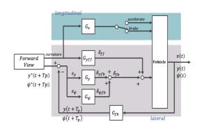
図-5 ドライバモデルのブロック線図
