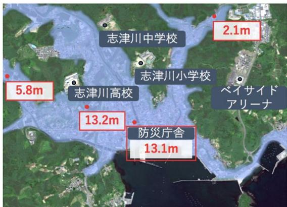
図2 平成23年東北地方太平洋沖地震にともなう津波浸水深（南三陸町）
