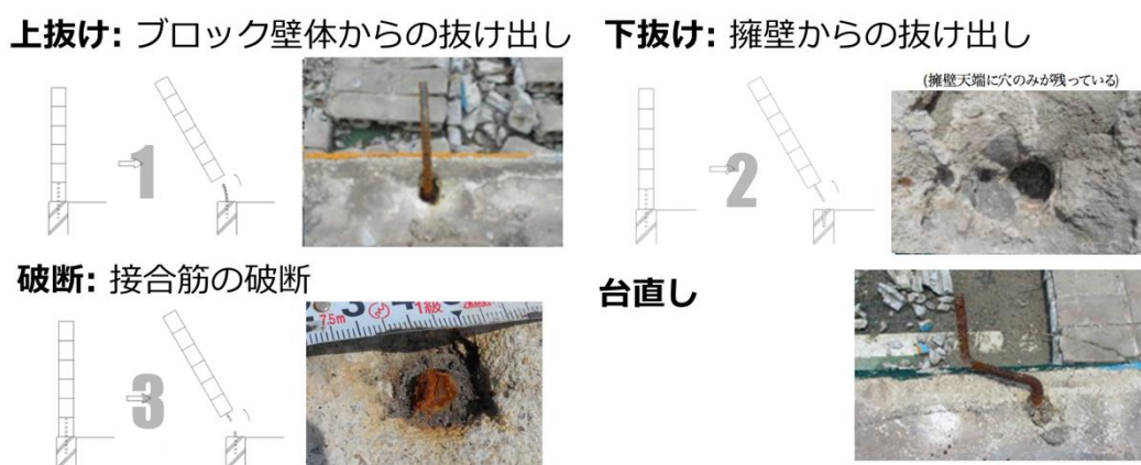
図4 当該ブロック塀で見つかった接合筋の破損のパターン (報告書 1) の図を元に作成)
