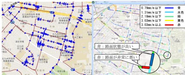
図3 道路区間段差表示 道路平坦性表示
