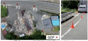
図5GCPの配置図と使用した標定点
