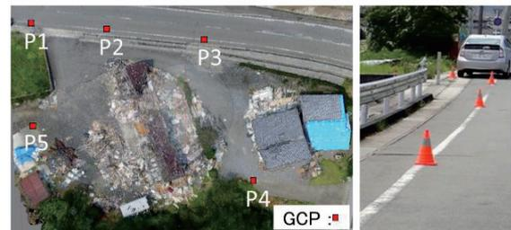
図 5 GCP の配置図と使用した標定点
