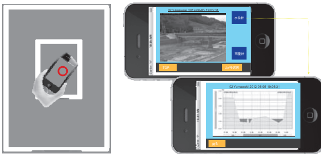
図1 ハザードマップを画像認識し、監視カメラ画像、水位データを呼び出す機能(イメージ)
