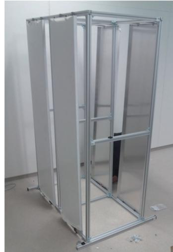
写真 2 傾斜測定用の実験装置
