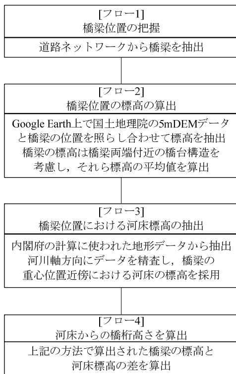
図1 橋桁高さ h_b の算出
