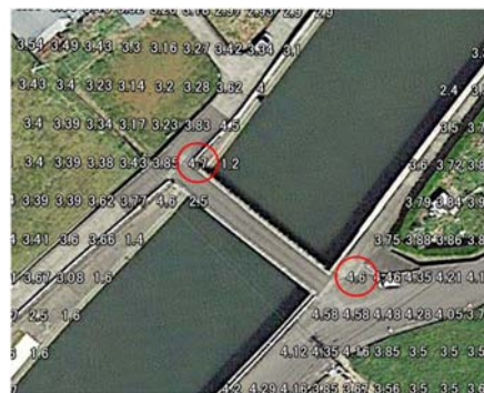
(a) 橋桁標高の抽出
