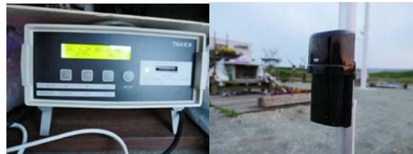
図1 来客カウンターおよび赤外線センサー外観
