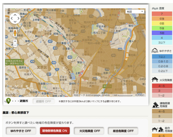
図3 建物倒壊危険度表示の画面
