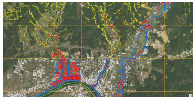
図4 推定被災エリア（青と黄）を使って抽出された推定被災建物（赤）
