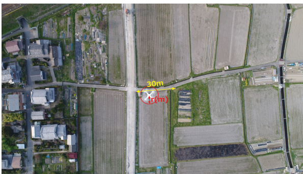
図-5 待機地点の UAV②が撮影した映像に映り込む撮影地点の UAV①の様子（撮影高度 150m, UAV 間距離 5m）
