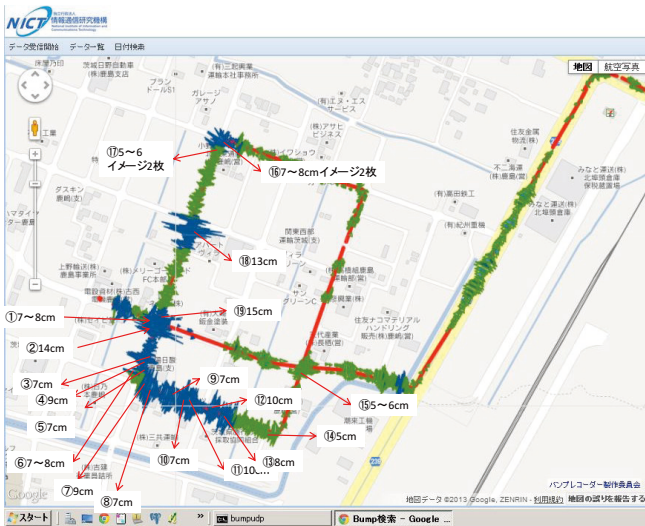
図6 本システムにより検出された段差高のデータと現地調査で得られたデータの重ね合わせ
