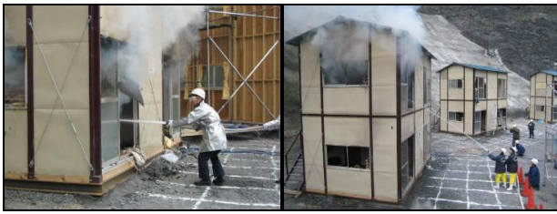
図4 D級可搬消防ポンプを用いた消火活動状況
