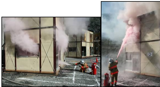
図5 大型消火器（粉末）を用いた消火活動状況
