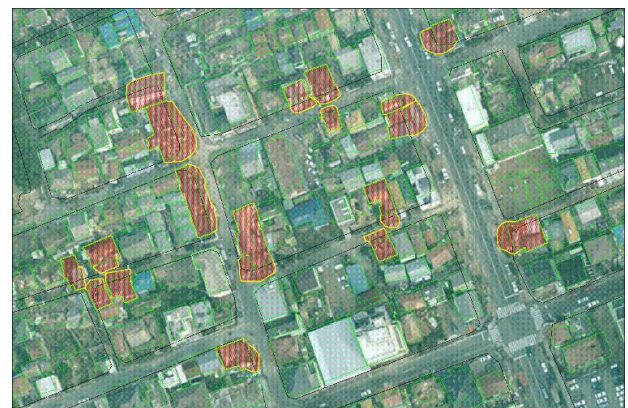
図 2 兵庫県南部地震時の瓦礫流出の状況 (1)
