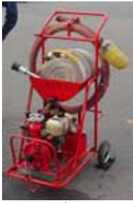
写真3 D級可搬ポンプ
