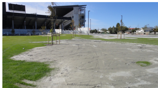
写真-4 Ami スタジアム前の液状化噴砂 (シルト分が多く、色が灰色、2011.3.4)
